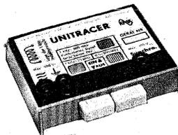
Nadelimpulse wahlweise 1 kHz/500 kHz, Oberwellen bis 25 bzw. 500 MHz. Gittermuster-generator für Fernsehen, Signal amplituden-, phasen- und frequenzmoduliert, daher auch für FM geeignet.
