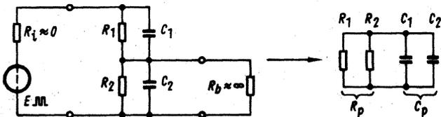
Bild 5.8. Frequenzkompensierter Spannungsteiler, Ersatzschaltbild zum Berechnen der Zeitkonstante
