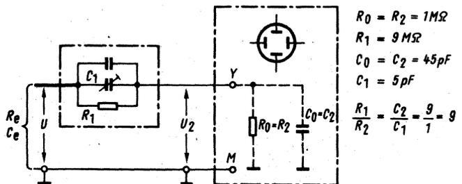
Bild 5.9. Oszilloskop mit Tastkopf und frequenzkompensiertem Spannungsteiler
