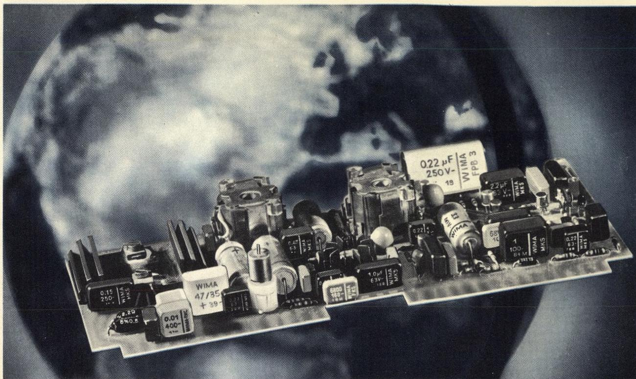
**WIMA-MKS-Kondensatoren** (metallisiert) sind gebräuchliche Bauelemente neuzeitlicher Verstärkertechnik. **WIMA-FKS**-(Polyester mit Folienbelägen) und **WIMA-FKC-Kondensatoren** (Polycarbonat) sind Ergänzungstypen im unteren Kapazitätswertebereich.
