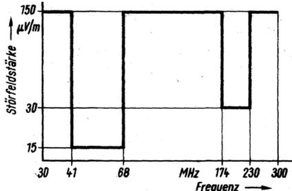
Zulässige Störleistung von UKW-Empfängern im Bereich 30...300 MHz, gemessen in 30 m Entfernung
