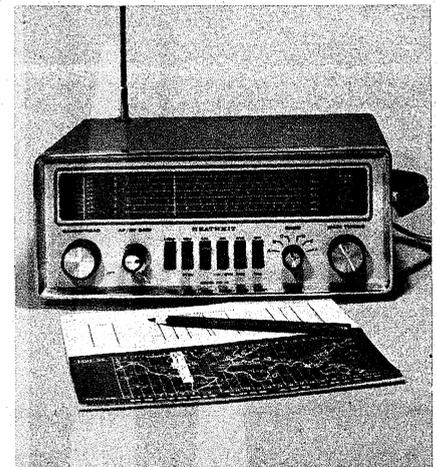
Bild 1. Ansicht des Kurzwellenempfängers GR-78 von Heathkit (Aufnahme: Leutmayr)
