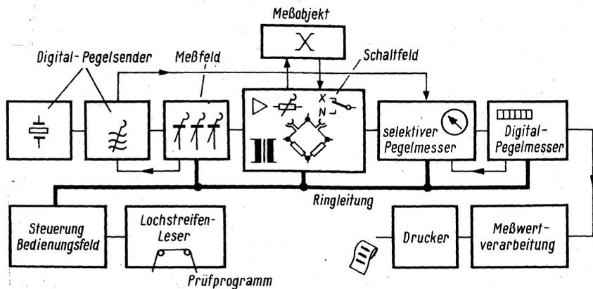
Bild 2. Blockschaltbild eines mit Pegamat-Bausteinen aufgebauten programmierbaren Meßplatzes
